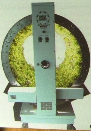
6. Ce système hydroponique rotatif réalise un tour complet en moins d'une heure. Il peut contenir près de 300 plants selon le modèle et la taille des plantes. Il est muni d'un bassin au bas, dans lequel les racines des plantes trempent à tour de rôle.
